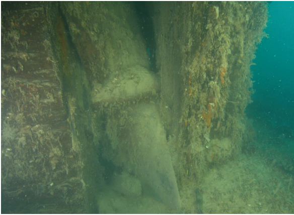
Figure 4.1.2 : Hélice en position de service dans la cage à hélice de Terror (photo : M. A. Bernier, Parcs Canada, 90Mo2819EF)
