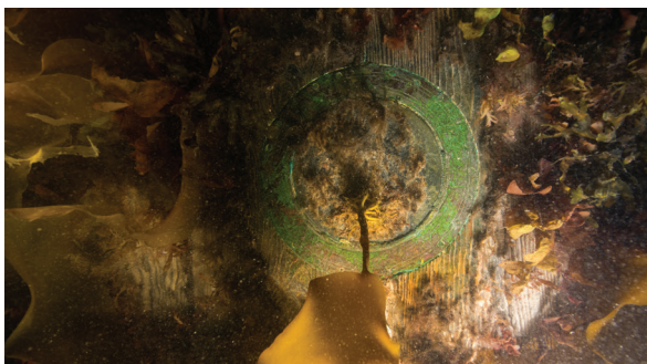
Figure 5.2.8 : Illuminateur de pont breveté Preston (Photo : T. Boyer, Parcs Canada; 89M00629EF).
