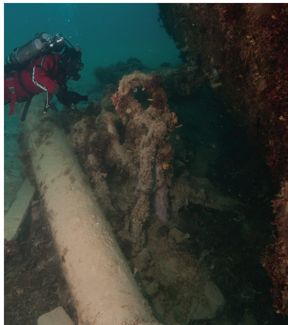
Figure 5.5.10 : Espar, ancre de bossoir tribord et chaîne d'ancre au pied de l'étrave (Photo : J. Moore, Parcs Canada; 89Mo6487EF).
