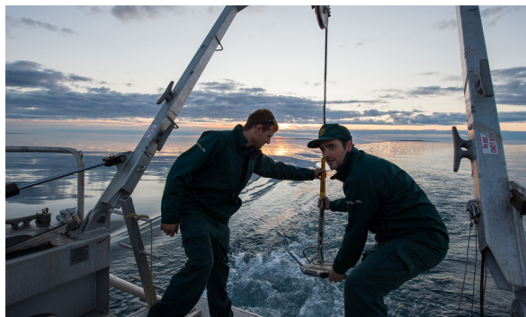
Figure 3.3.3 : Récupération du sonar à balayage latéral à bord de Investigator à la fin d'une journée de prospections (Photo : J. Moore, Parcs Canada; 51M2848EF).
