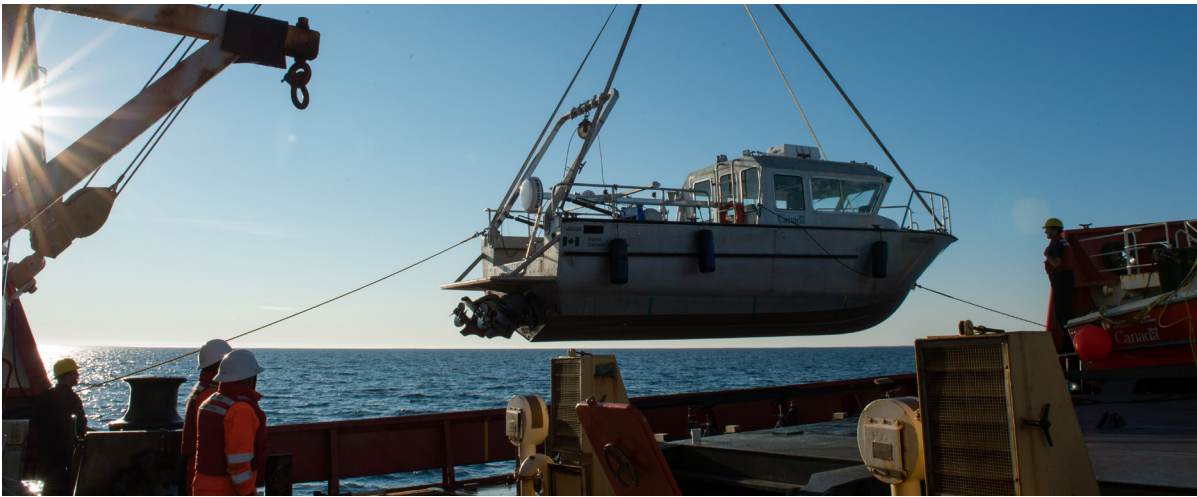
Figure 1.3.1 : Mise à l'eau du navire de recherche de Parcs Canada Investigator à l'aide d'une grue depuis le pont du NGCC Sir Wilfrid Laurier pour une journée de prospection dans la baie Queen Maud, au Nunavut (photo : J. Moore, Parcs Canada; 89M0011EF).
