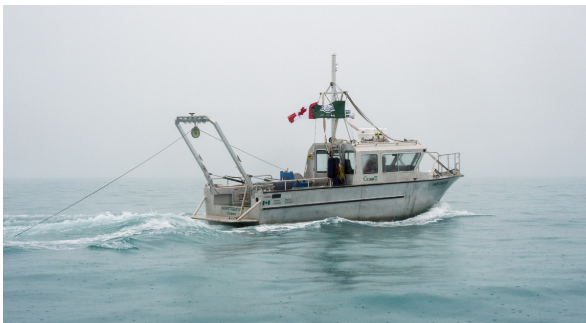
Figure 3.2.2 : Le navire de recherche Investigator remorquant un sonar à balayage latéral en 2013 (Photo : T. Boyer, Parcs Canada; 51M2495EF).
