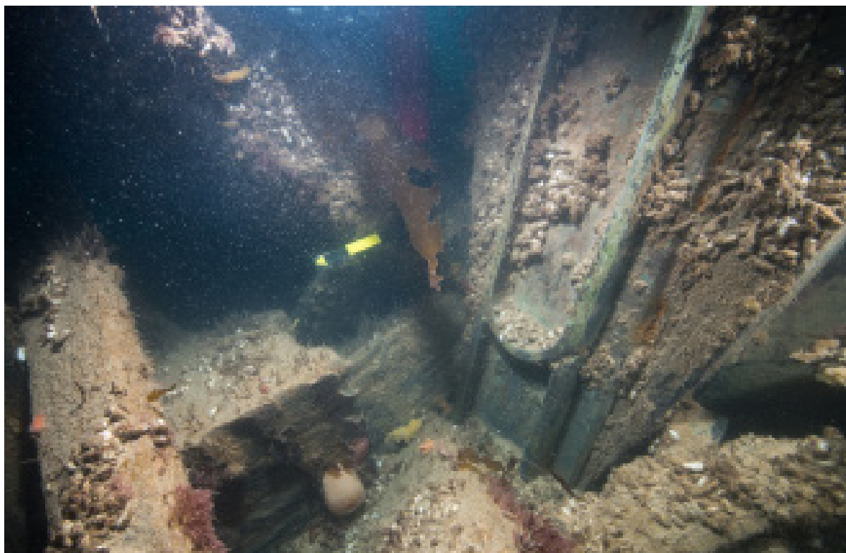
Figure 5.2.8 : L'étambot arrière (à droite, déplacé vers l'arrière du côté tribord) est sorti de son emplacement d'origine sur la quille. Des rails de guidage en bronze coulé servant à abaisser et à retirer l'hélice sont visibles sur la face avant de l'étambot (photo : T. Boyer, Parcs Canada; 89Mo592EF).
