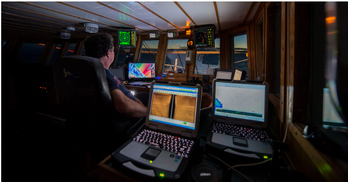
Figure 3.2.4 : Opérations nocturnes de sonar à balayage latéral à bord du Martin Bergmann (Photo : T. Boyer, Parcs Canada; 51M2840EF).
