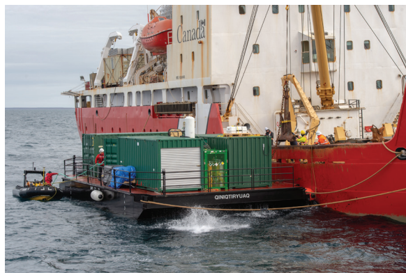
Figure 4.1 : L'équipage du NGCC Sir Wilfrid Laurier déploie une ancre de corps mort sur la barge Qiniqtiryuaq tandis que le personnel de Parcs Canada positionne les lignes d'amarre (photo : J. Moore, Parcs Canada; 89M09435EF).
