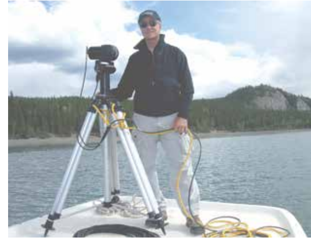
Wayne Loeber posant avec le sonar à balayage mécanique BlueView BV5000. Photo : Mark Thomas
