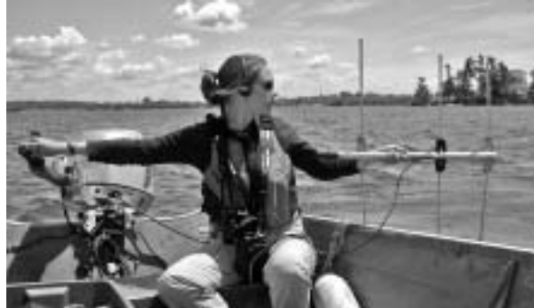
La chercheuse Marie-Andrée Carrière tient un récepteur au dessus de l'eau pour localiser une des 22 tortues géographiques du fleuve Saint Laurent qui portent un transmetteur. Chaque transmetteur a sa fréquence propre, afin de permettre le suivi et la localisation de chaque tortue.
