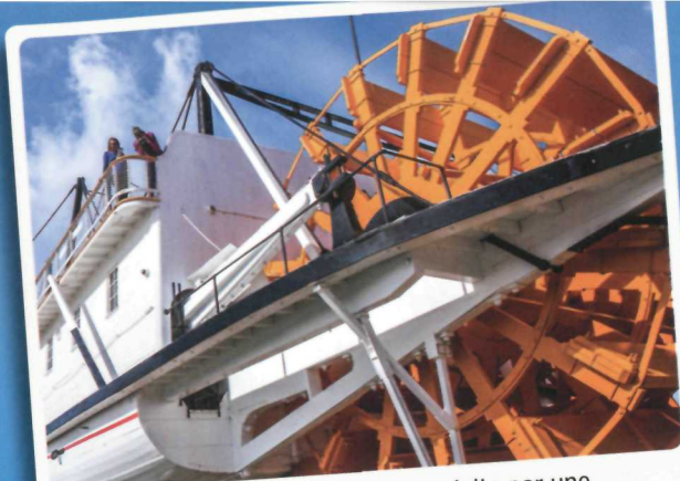
Vapeur Klondike : De la vapeur produite par une immense chaudière alimentait deux moteurs de type condenseur à injection, qui faisaient tourner la roue à aubes. (Parcs Canada / P. Gowdle)
